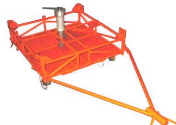
**ТЕЛЕЖКА ДЛЯ ГЛ. РЕДУКТОРА, ДВИГАТЕЛЯ, АППАРАТА ПЕРЕКОСА, ВТУЛКИ НВ**
