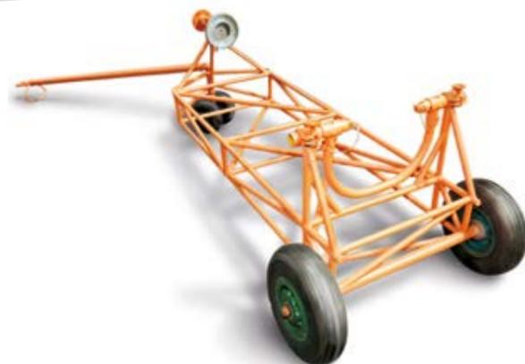
**ТЕЛЕЖКА ДЛЯ ПЕРЕВОЗКИ И ПРЕДВАРИТЕЛЬНОГО МОНТАЖА ДВИГАТЕЛЯ**
