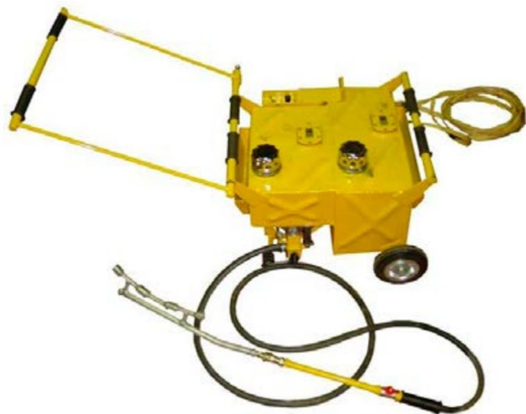
**УСТАНОВКА ДЛЯ ПРОМЫВКИ КОМПРЕССОРА ДВИГАТЕЛЯ**
