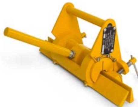
**ПРИСПОСОБЛЕНИЕ ДЛЯ ОТГИБА ТРИММЕРНЫХ ПЛАСТИН**
