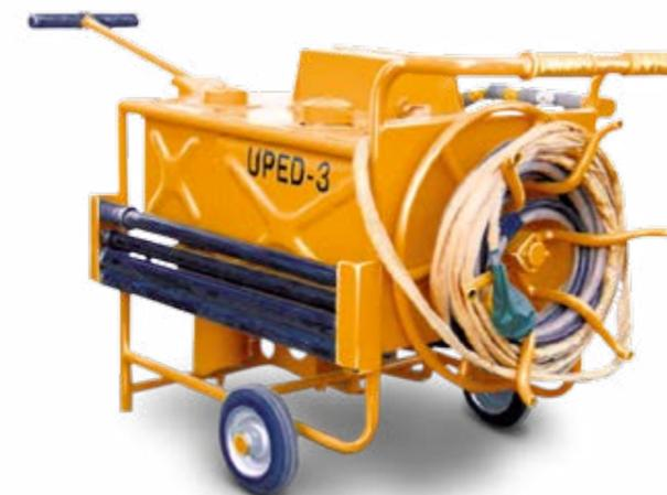
**УСТАНОВКА ДЛЯ ПРОМЫВКИ И ЭМУЛЬСИРОВАНИЯ ДВИГАТЕЛЕЙ**
