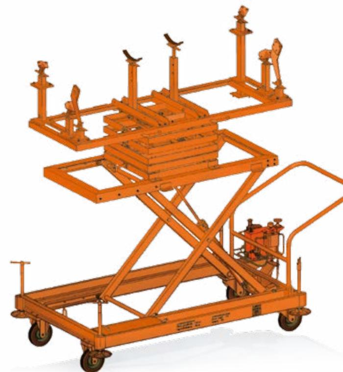
**ПРИСПОСОЛЕНИЕ ДЛЯ МОНТАЖА/ДЕМОНТАЖА УОВ**
