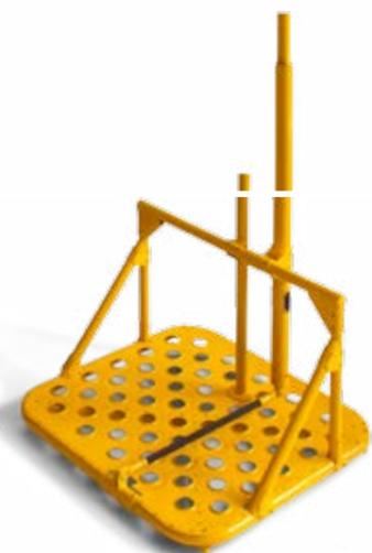
**УСТАНОВКА ДЛЯ ПРОВЕРКИ СОКОНУСНОСТИ ЛОПАСТЕЙ НВ**
